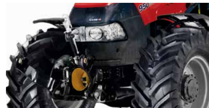
Naadloos geïntegreerde frontheef met een hefvermogen tot 2.250 kg.
