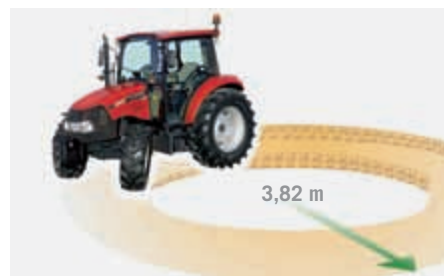
Draaicirkel van 3,82 m (Farmall 55 C - 75 C) en 4,33 m (Farmall 85 C - 115 C).
