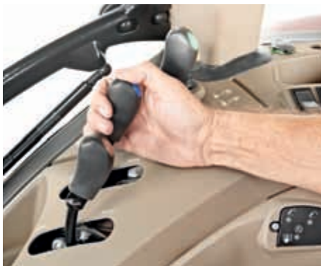
Tot drie mechanische regelventielen achteraan zijn verkrijgbaar voor de Farmall C-reeks.
