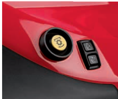
Externe bedieningen voor een snelle en eenvoudige aankoppeling van werktuigen.
