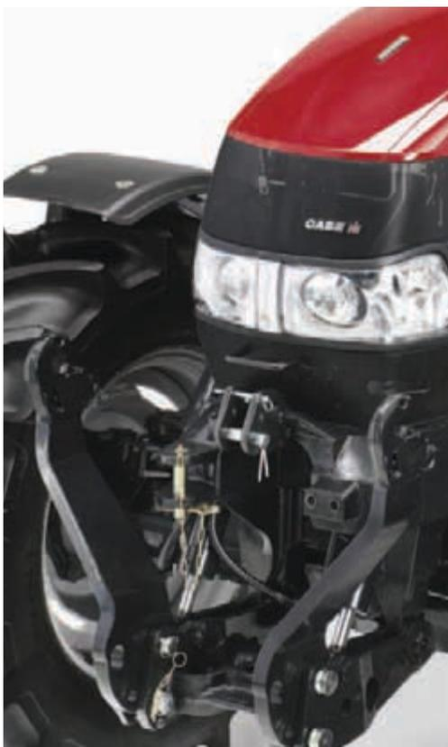
Un relevage avant parfaitement intégré avec une puissance de levage allant jusqu'à 3 800 kg. Une gestion d'attelage avant optionnelle est disponible pour les Maxxum Multicontroller et CVX.
