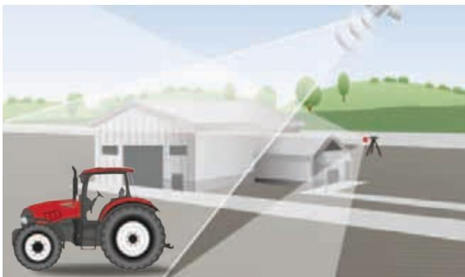
Le **xFill** comble les manques du signal RTK jusqu'à 20 minutes.
