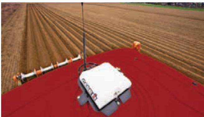
**AFS AccuGuide™** : un guidage basé sur GPS et GLONASS pour une précision ultime indépendante des conditions de cultures. Des niveaux de précision disponibles jusqu'à 2,5 cm.
