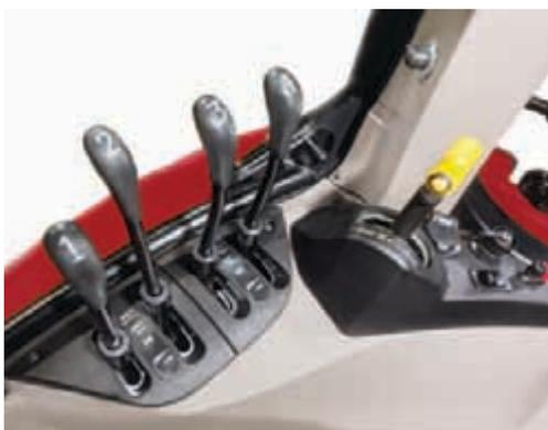
Jusqu'à 4 distributeurs auxiliaires mécaniques disponibles sur les modèles Maxxum.
