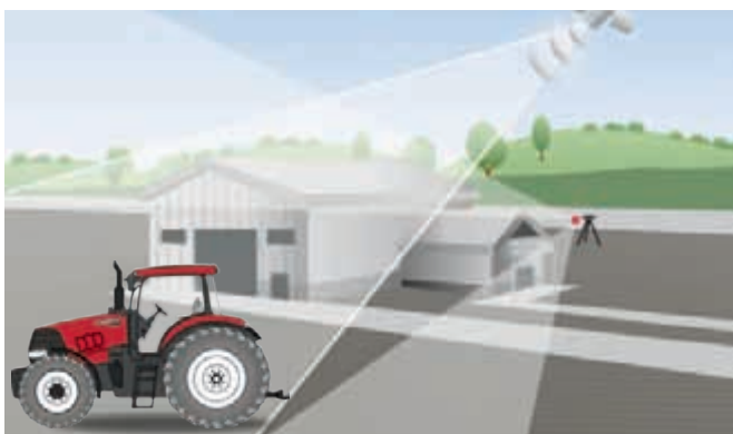
Le xFill comble les lacunes du signal RTK jusqu'à une durée de 20 minutes.
