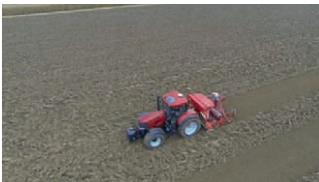
AFS AccuGuide : guidage basé sur le GPS et le système GLONASS pour une précision ultime indépendante des conditions de cultures. Avec les niveaux de précision RTK jusqu'à 2,5 cm disponibles.
