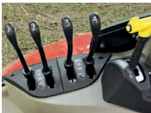
Jusqu'à quatre distributeurs auxiliaires mécaniques disponibles pour les modèles Puma et Puma CVX 130-160.
