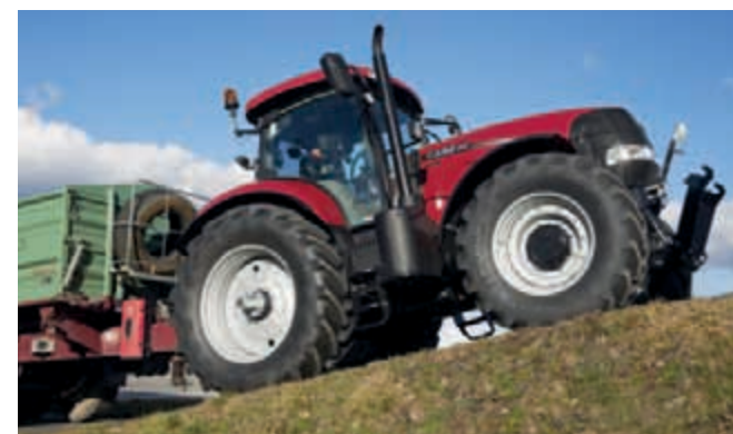
La fonction Active Stop maintient le tracteur à l'arrêt sans utiliser les freins.
