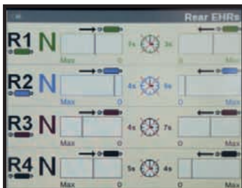
Contrôlez vos distributeurs auxiliaires grâce au moniteur AFS Pro 700.
