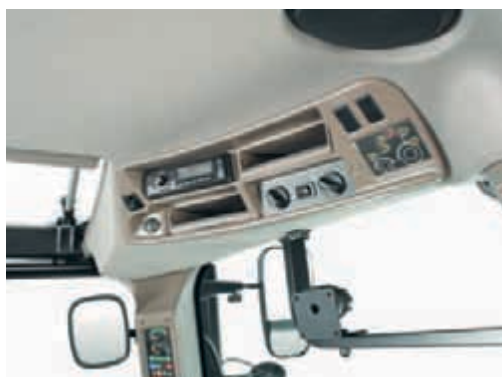
Un panneau lumineux central, des commandes de climatisation et de radio bien intégrés dans le toit.
